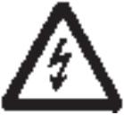
**SHOCK HAZARD** - DO NOT TOUCH UN-INSULATED BATTERY, CONNECTORS OR TERMINALS. BE SURE TO DISCHARGE STATIC ELECTRICITY FROM TOOLS AND TECHNICIAN BY TOUCHING A GROUNDED SURFACE IN THE VICINITY OF THE BATTERIES BUT AWAY FROM THE CELLS AND FLAME ARRESTERS.
